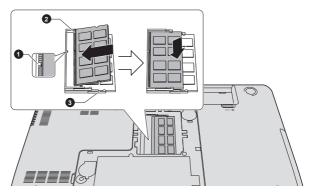
1. Notch 2. Slot B 3. Slot A
